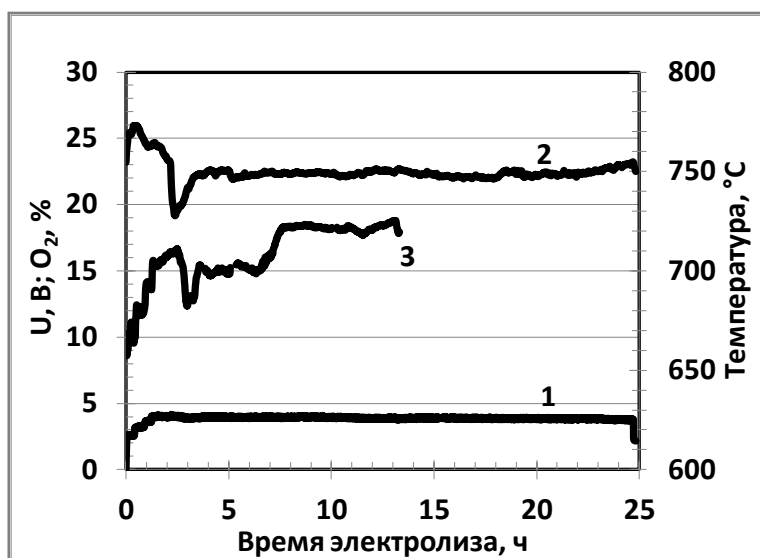
Рисунок 29 - Параметры 1000 А электролиза: 1 – напряжение, 2 – температура, 3 – содержание кислорода в выходящем газе
