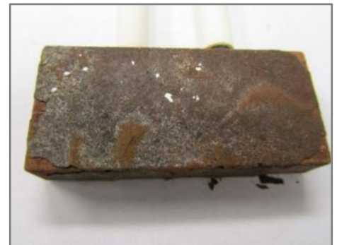
Рисунок 23- Анод покрыт плотным оксидным слоем после электролиза в \text{KF-AlF}_3\text{-NaF(2 мас.%)}\text{-Al}_2\text{O}_3 при 1023 К (750°C)
