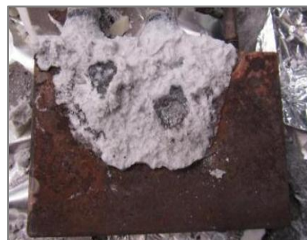
Рисунок 28 - Анод после 100 А электролиза. На поверхности – две Al капли
