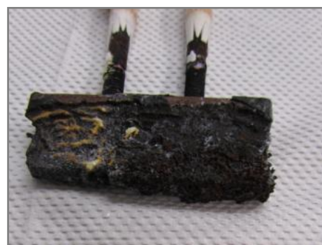
Рисунок 21 - Прокорродировавший анод после электролиза в \text{KF-AlF}_3\text{-Al}_2\text{O}_3 при 1003 К (730°C).
