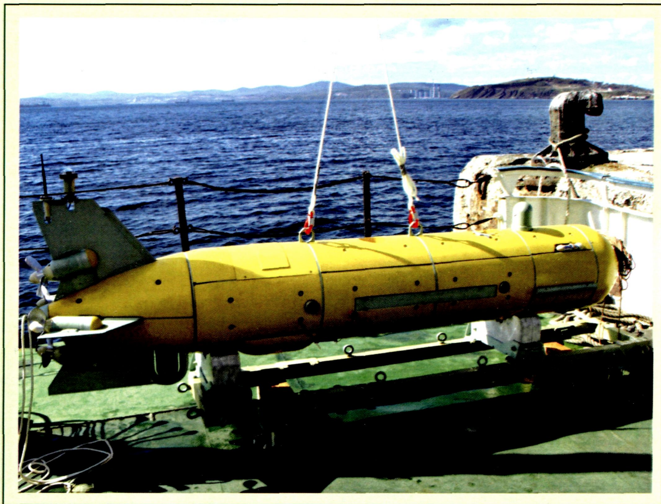
Рис. 2. Автономный необитаемый подводный аппарат типа МТ-2010
