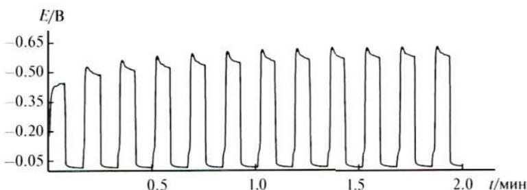
Изменение потенциала в процессе осаждения цинка в импульсном режиме при  $\tau_1/\tau_2 = 5/5$ .
