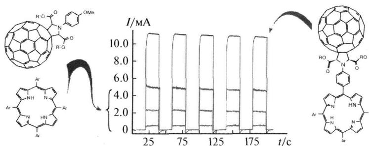
Значения токов при выключенном и включенном светодиоде для устройств на основе бинарных порфиринов-фуллерен и ковалентно связанных порфиринов-фуллереновых диал.
