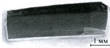
Поперечный шлиф образца расплава при охлаждении с 1180 °C в режиме I (в воду): желтое стекло — расплав, который контактировал с воздухом (верхний слой), черное стекло — расплав, который контактировал с дном тигля (нижний слой), и поликристаллическая середина ( $\delta^*\text{-Bi}_2\text{O}_3$ ).
