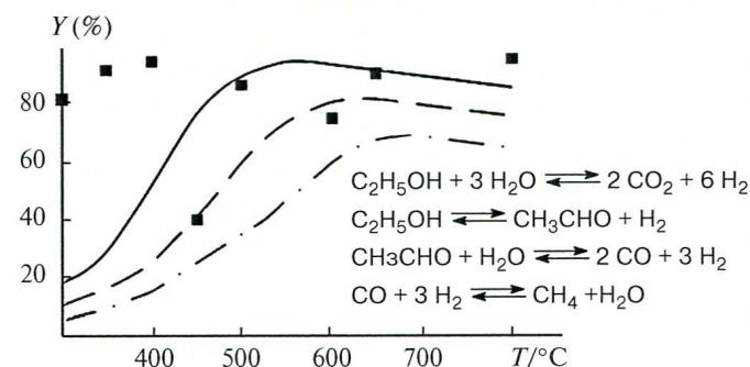
Температурные зависимости выхода водорода ( $Y$ ) в паровом риформинге этанола: кривые — равновесные значения, точки — экспериментальные данные.
