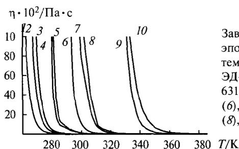
Зависимость вязкости ряда эпоксидных олигомеров от температуры: DER-354 (1), ЭД-22 (2), ЭД-20 (3), NPPN-631 (4), DEN-431 (5), ЭД-16 (6), NPPN-638 (7), УП-643 (8), ЭД-8 (9) и ЭД-10 (10).
