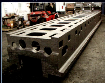
Чугунные отливки опорной рамы и станины, масса 9000 кг и 16430 кг Завод Meuselwitz Guss, Германия
