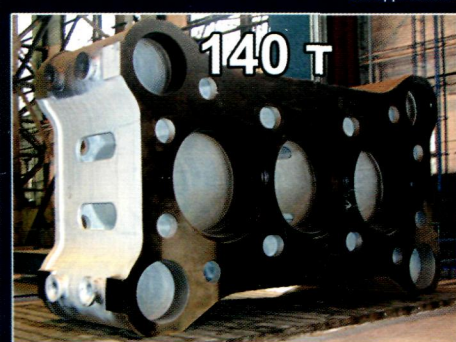
Стальные отливки Новоукраинского Машиностроительного Завода (НКМЗ, Украина) по ХТС-процессу Оборудование фирмы FAT, Германия. Траверса, 140000 кг; Барабан прокатного стана, 22600 кг
