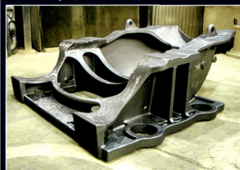
Чугунные отливки опорной рамы и станины, масса 9000 кг и 16430 кг Завод Meuselwitz Guss, Германия
