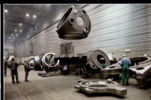
Корпус вента ветряного генератора, масса – 34 000 кг Завод Torgelow, Германия
