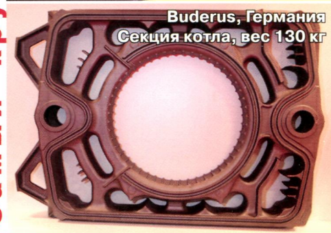
Сейатцу-процесс Завод Buderus, Германия
