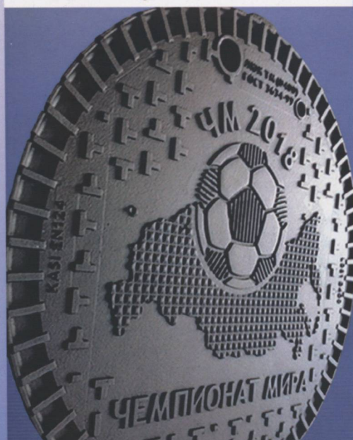
Сейатцу-процесс Завод KASl, Чехия. АФЛ 200 ф/ч Круглая опока Ø870x180 мм
