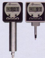
Головки измерительные ИГПЦ и ИПМЦ
