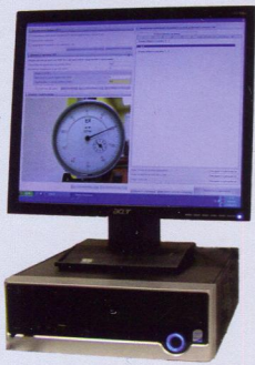
Прибор для поверки индикаторов ППИ-50
