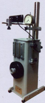
Прибор для поверки индикаторов ППИ-50
