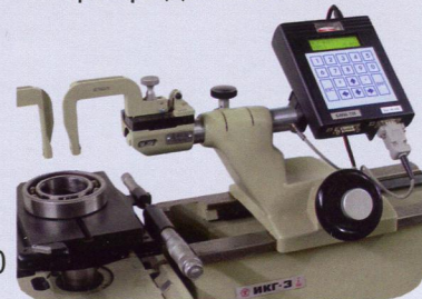
Индуктивная система М-200
