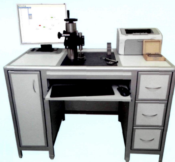
Установка для поверки концевых мер длины УКМ-100
