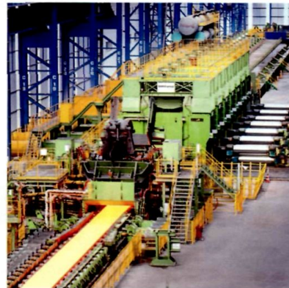
Фото на обложке: Безопасная установка Coilbox (впереди) и 7-клетевая чистовая группа (сзади) стана горячей прокатки полосы компании Habaş (Турция) SMS Group AG www.sms-group.com communications@sms-group.com
