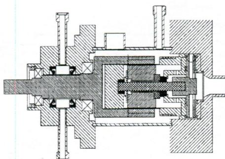
Центробежный насос расплавленных металлов
