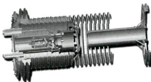
Ускорительная трубка инжектора ионов
