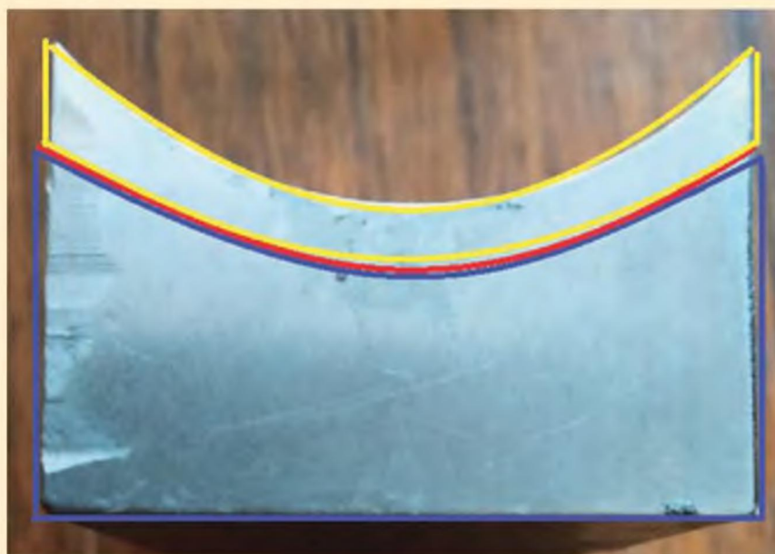
Рис. 5. Наплавленный образец с выделением областей для исследования микроструктуры
