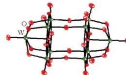
**Кристаллическая структура  $[Co(NH_3)_5Cl]_2(W_{10}O_{32}) \cdot 4H_2O$**
